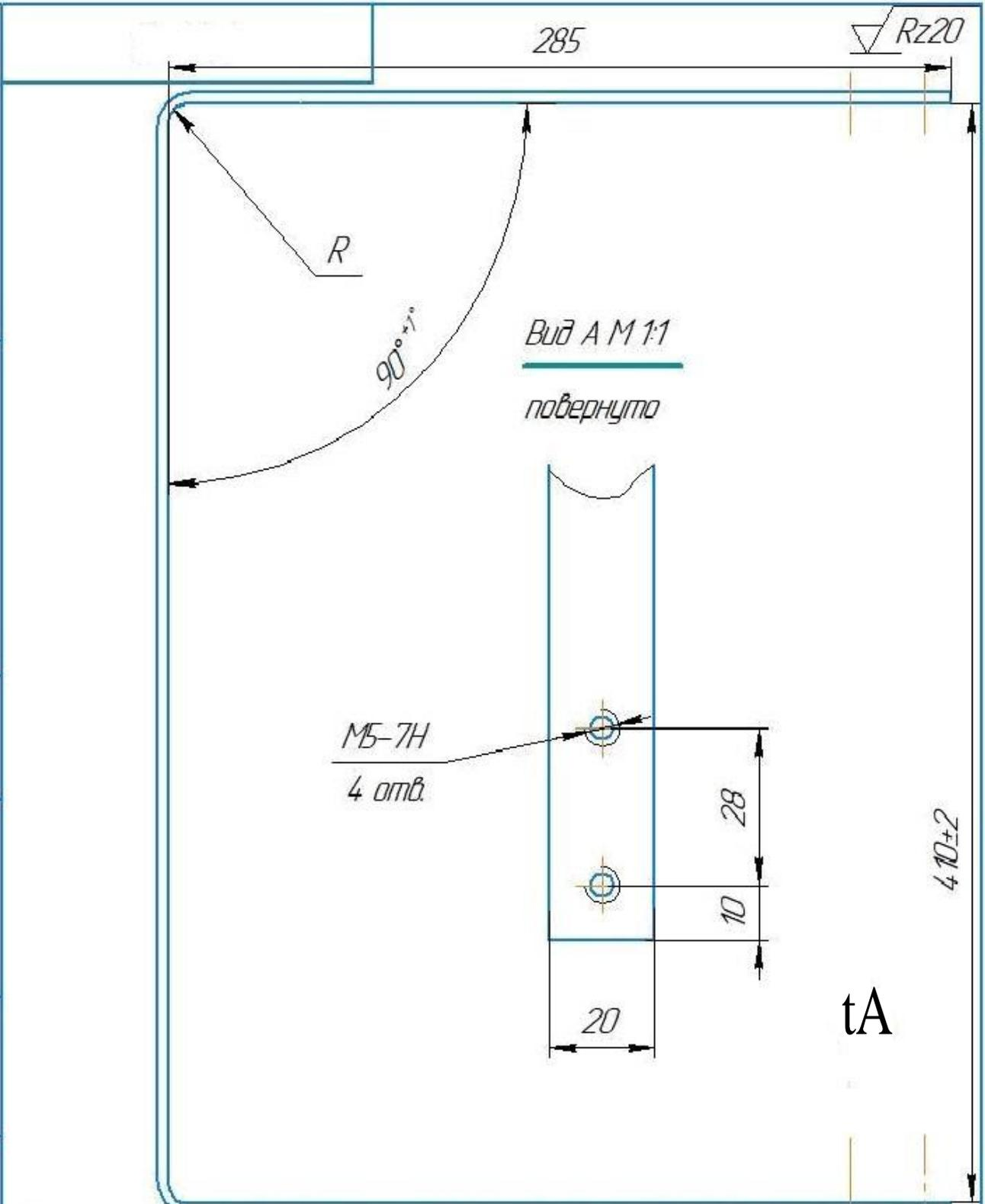
1. Неуказанные предельные отклонения размеров охватываемых поверхностей h12, охватывающих поверхностей H12, прочих  $\pm IT12/2$ .
